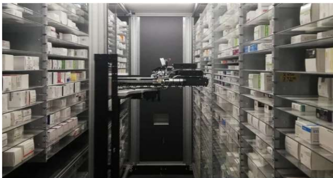
Brazo robotizado del robot de dispensación de medicamentos a pacientes externos.
